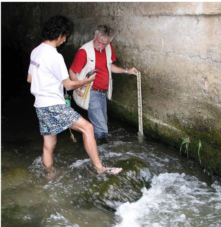
Illustration 244 – Pose d'une échelle limnimétrique sur le Río Seco, Soloco, Chachapoyas, Amazonas (16-7-2005).
